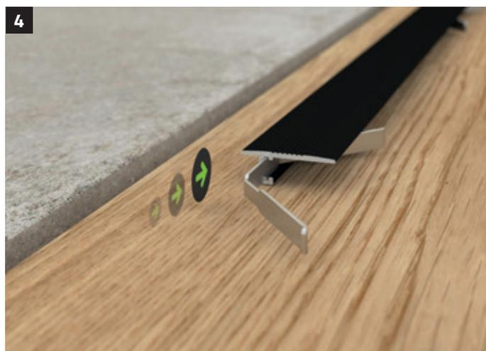
Die Montageclips werden stirnseitig in das Übergangsprofil eingeschoben. Achtung: In der Übergangsleiste sind zwei gegenüberliegende Vorsprünge eingearbeitet, zwischen denen die Montageclips leichtgängig geführt werden.
