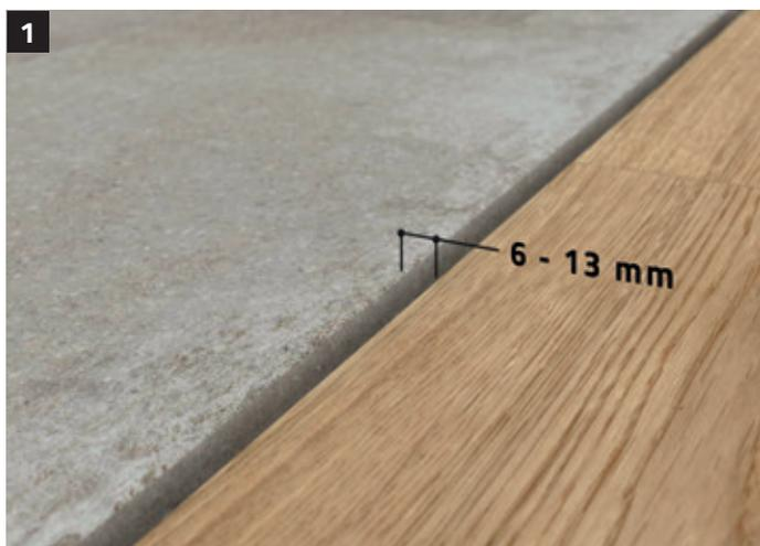
Die Breite der Übergangsfuge sollte zwischen 6 und 13 mm sein. Ebenfalls zu berücksichtigen ist die Stärke des Bodenbelags. Unsere Systeme des Typs X5 können bereits ab einer minimalen Bodenbelagsstärke von 5 mm eingesetzt werden.
