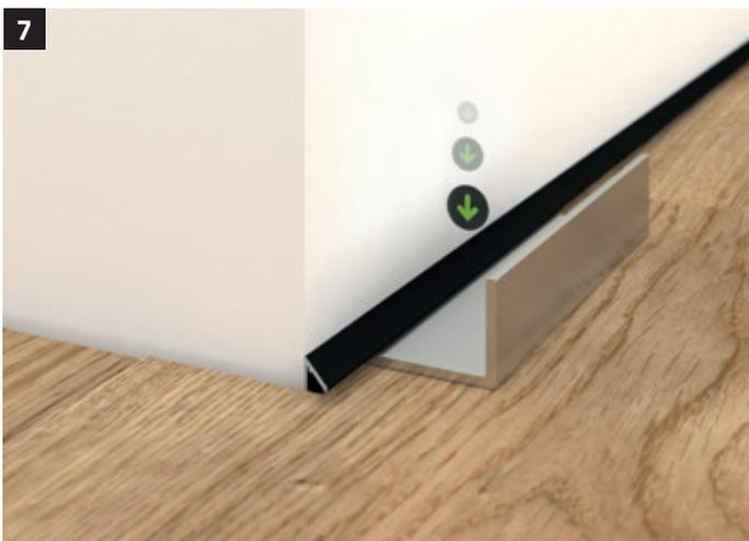
Sobald der Spannvorgang abgeschlossen ist, wird das Abschlussprofil nach unten gedrückt und die Montagehilfe abgezogen. Nun wiederholt sich der Spann- und Montagevorgang, bis alle Montageclips eines Abschlussprofils gespannt und versenkt sind. Zu evtl. Korrekturen kann das Abschlussprofil jederzeit aus der Anschlussfuge entnommen werden.
