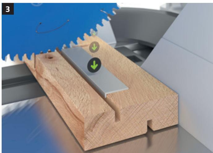
Die Profile werden passend abgelängt. Hierbei wird in einem Arbeitsgang der Gehrungsschnitt für Innen- oder Außenecke angebracht. Das Profil wird dabei sicher in unserer Schritthilfe positioniert. Das Profil kann somit beim Schneidevorgang nicht verkanten.
