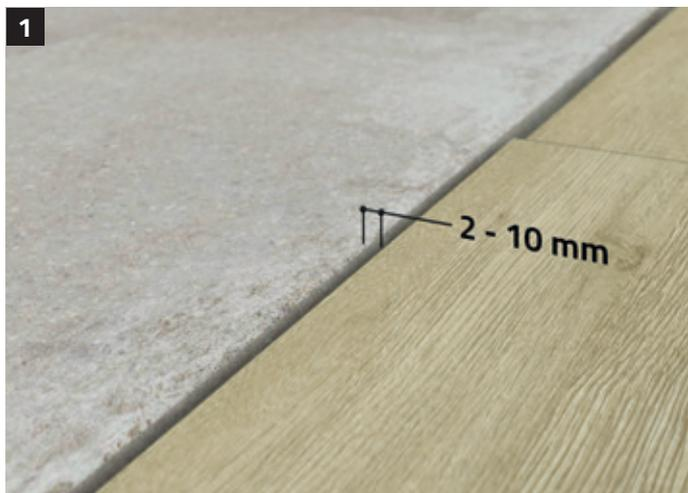
Die Breite der Übergangsfuge sollte zwischen 2 bis 10 mm sein. Ebenfalls zu berücksichtigen ist die Stärke des Bodenbelags. Unsere Systeme des Typs X2 können bereits ab einer minimalen Bodenbelagsstärke von 2 bis 5 mm eingesetzt werden.
