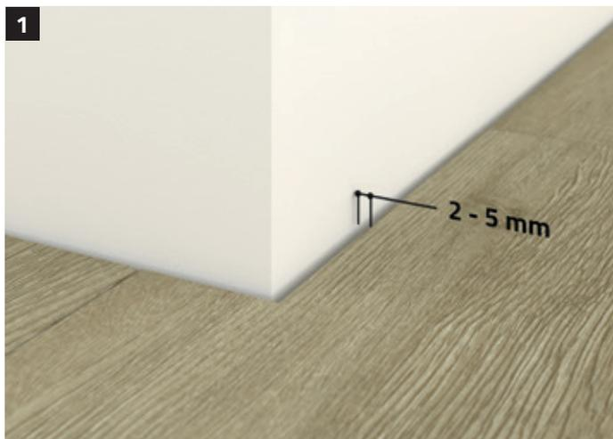
Die Breite der Anschlussfuge sollte zwischen 2 und 5 mm sein. Ebenfalls zu berücksichtigen ist die Stärke des Bodenbelags. Unsere Systeme des Typs X2 können bereits ab einer minimalen Bodenbelagsstärke von 2 mm bis 5 mm eingesetzt werden.
