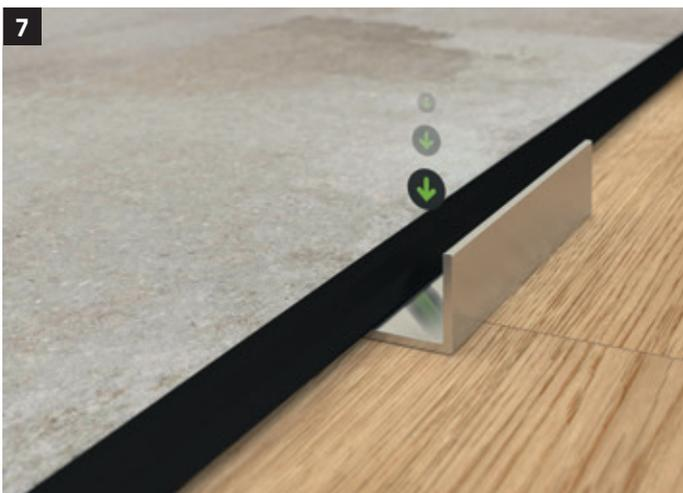
Sobald der Spannvorgang abgeschlossen ist, wird das Übergangsprofil nach unten gedrückt und die Montagehilfe abgezogen. Nun wiederholt sich der Spann- und Montagevorgang, bis alle Montageclips eines Übergangsprofils gespannt und versenkt sind. Zu evtl. Korrekturen kann das Übergangsprofil jederzeit aus der Übergangsfuge entnommen werden.
