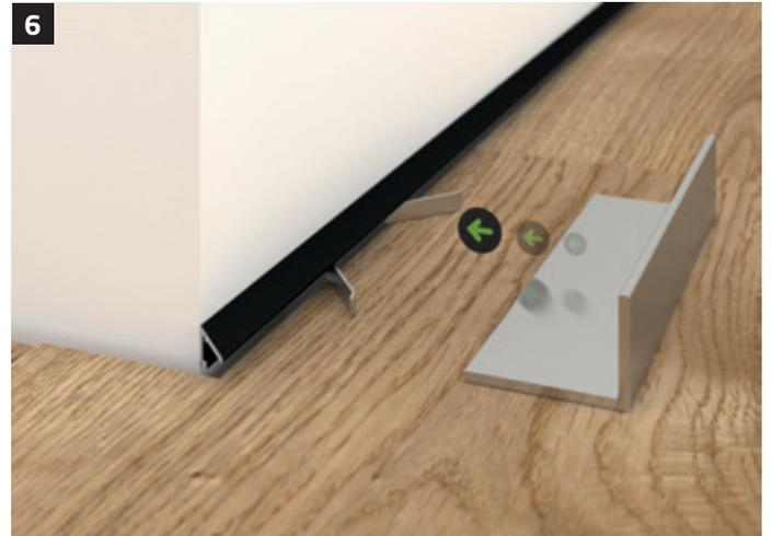
Das Abschlussprofil mit den eingeschobenen Montageclips wird nun an der Wandfläche in Montageposition gebracht. Mit der Montagehilfe werden die Montageclips vorsichtig aufgespreizt, indem mit der Montagehilfe die Montageclips Richtung Wand gedrückt werden.
