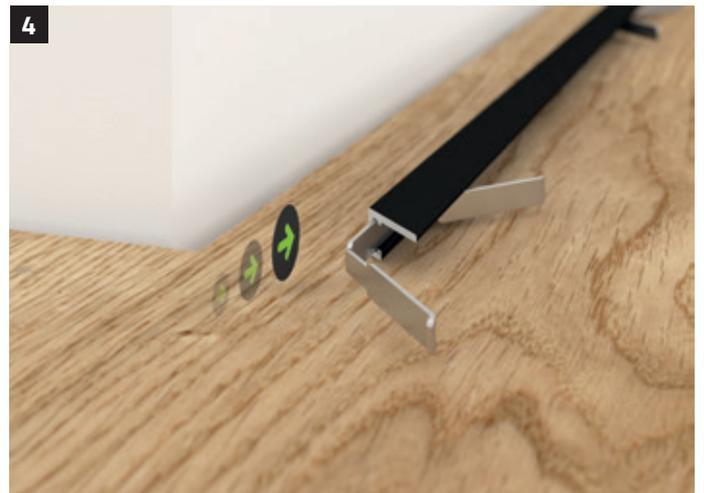
Die Montageclips werden stirnseitig in das Abschlussprofil eingeschoben. Achtung: In der Abschlussleiste sind zwei gegenüberliegende Vorsprünge eingearbeitet, zwischen denen die Montageclips leichtgängig geführt werden.
