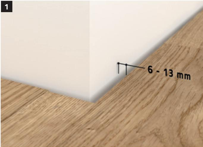
Die Breite der Anschlussfuge sollte je nach verwendetem Abschlussystem zwischen 6 und 13 mm sein. Ebenfalls zu berücksichtigen ist die Stärke des Bodenbelags. Unsere Systeme des Typs X5 können bereits ab einer minimalen Bodenbelagsstärke von 5 mm eingesetzt werden.
